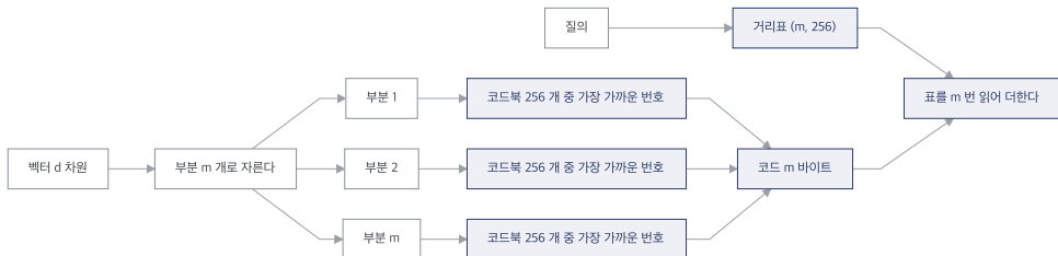
그림 13.3.. 곱 양자화. 벡터를 부분 m 개로 자르고 부분마다 코드북에서 번호 하나를 고른다. 질의는 거리표를 만들고 코드마다 표를 m 번 읽는다
